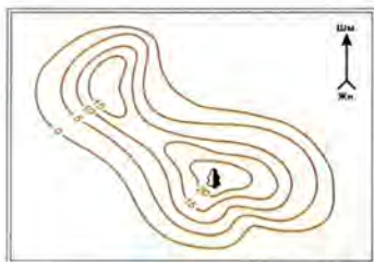
18-расм. Тепаликни горизонтал рейка ёрдамида планга тушириш
